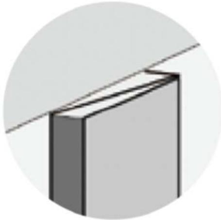
Instale el marco en la pared (Madera o Metalcom) y luego comience a colocar el revestimiento REM desde la parte inferior
